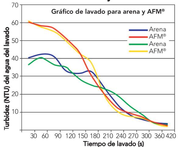
La curva de lavado compara el lavado de un filtro de arena con uno de AFM®. El filtro con AFM® expulsó un 30% más de suciedad que el de arena.
